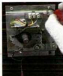
拆下执行器固定螺钉
